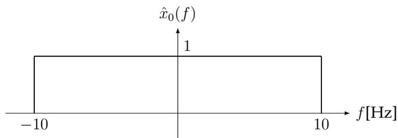
Das Spektrum des Signals  $x(t)$  ist nach dem Faltungstheorem gegeben durch  $\hat{x}(f) = (\hat{x}_0 * \hat{x}_0)(f)$  als
