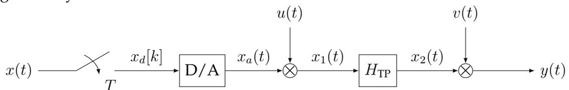
Abtastung von  $x(t)$  ergibt das zeitdiskrete Signal  $x_d[k] = x(kT)$ . Der D/A-Wandler ist charakterisiert durch die Eingangs-Ausgangsbeziehung
