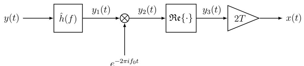
Hierbei ist  $\hat{h}(f)$  der Frequenzgang aus der Aufgabenstellung. Um zu erkennen wie die schrittweise Rekonstruktion verläuft, ist es hilfreich sich die Spektren  $\hat{y}_1(f)$ ,  $\hat{y}_2(f)$  und  $\hat{y}_3(f)$  der Zwischensignale  $y_1(t)$ ,  $y_2(t)$  und  $y_3(t)$ , respektive, zu veranschaulichen:
